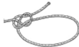
**Einfacher Schotstek** dient zum Zusammenstecken von zwei Leinen, insbesondere von solchen unterschiedlicher Stärke. Die dünnere Leine wird immer durch die Bucht der dickeren gesteckt.
