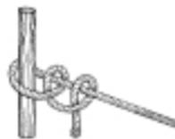
**Belegen von Enden:** Das Ende der Leine wird achtförmig um die Klampe oder den Beleg nagel gelegt, wobei zunächst mit einem Rundtörn begonnen wird, der sich nicht selbst bekneifen darf, damit das Ende der Leine gefiert werden kann. Der letzte Kreuzschlag wird zur Sicherung mit einem Kopfschlag versehen.
